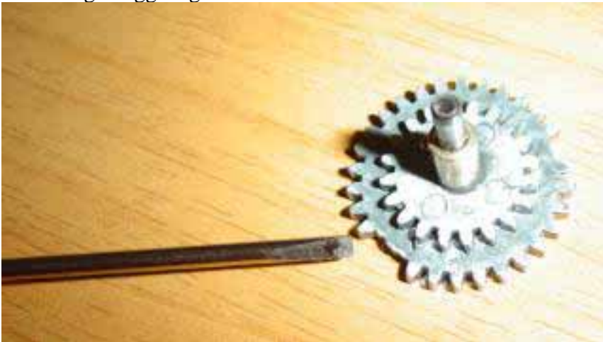
Sostituiamo gli ingranaggi originali con quelli in acciaio e albero motore in acciaio temperato:
